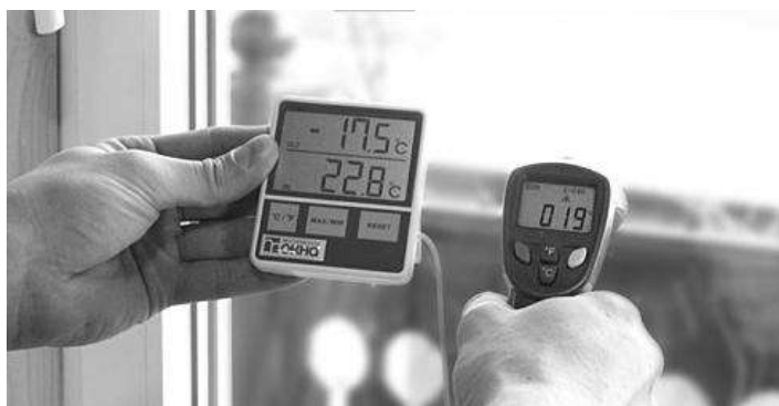
Рис. 11 – Замер температур при работе энергосберегающего стеклопакета из Ag (на улице -17,5 °С; в комнате 22,8 °С; поверхность стекла 19 °С)
