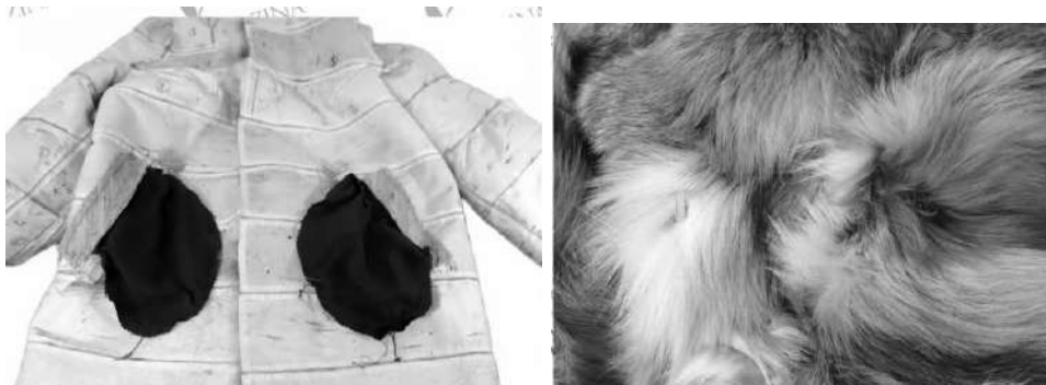
Рис. 4 – Обработка карманов и притачивание подборта
